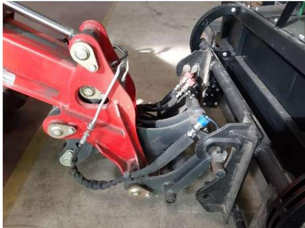
Abbildung 9: Ankuppeln des Farm Servant an das Schubfahrzeug
