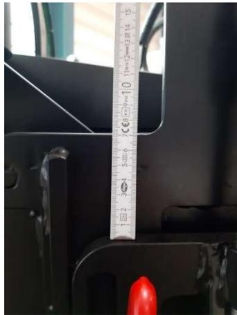
Abbildung 16: Messen der gleichmäßigen Höhenverstellung der Sammelwalze
