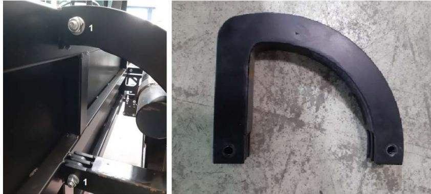
Abbildung 35: Komponenten der Aufnahmeohren
