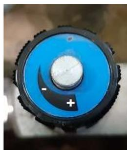
Abbildung 24: Drehrichtungen am Einstell-Ventil
