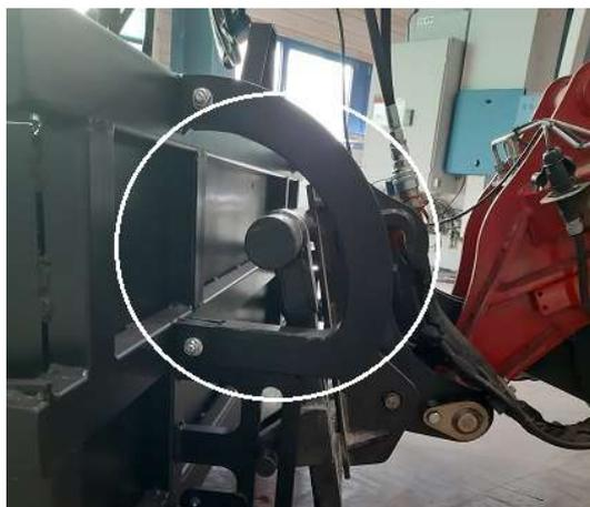
Abbildung 25: Richtige Position des Querrohres innerhalb der Aufnahmeohren
