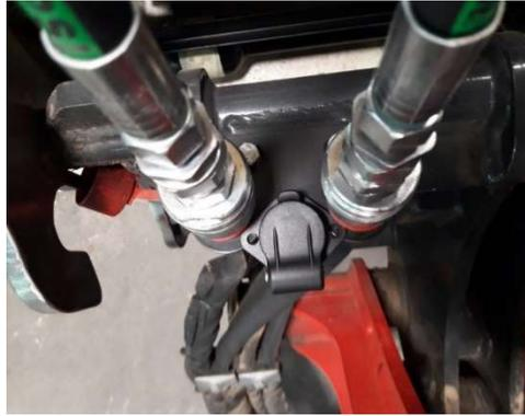
Abbildung 8: Position der Steckdose in der Nähe der Hydraulikanschlüsse
