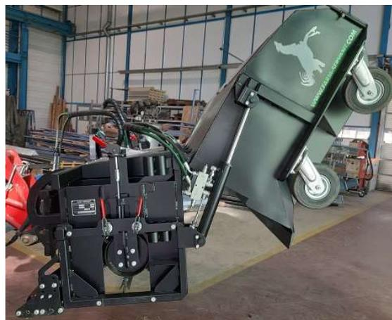
Abbildung 27: Entleerung des Frontanbaugerätes
