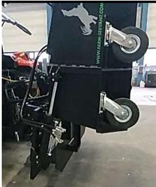
Abbildung 28: Entleerung des Heckanbaugerätes mit geöffnetem Schottblech
