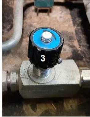
Abbildung 22: Ventil zum Einstellen der Walzengeschwindigkeit
