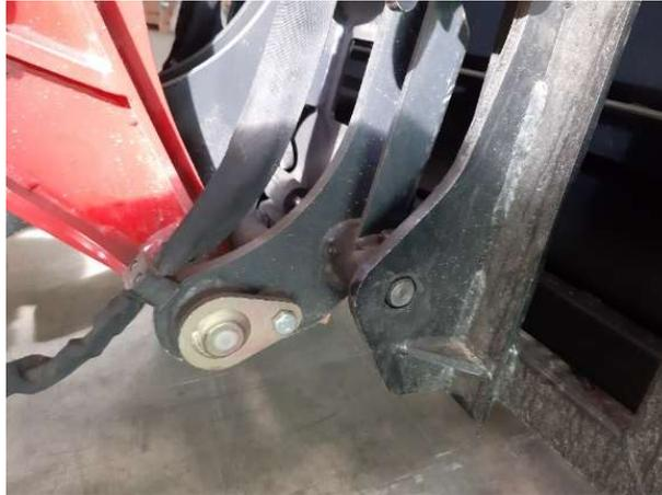
Abbildung 10: Geschlossene Verriegelung an der Aufnahme des Schubfahrzeuges
