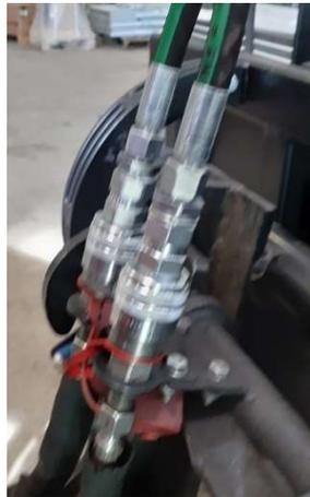
Abbildung 11: Angeschlossene Hydraulikleitungen
