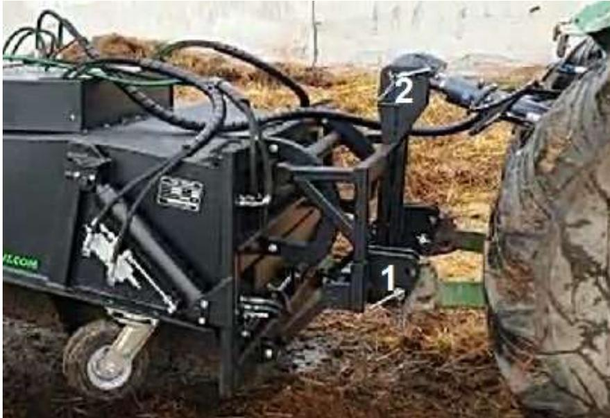
Abbildung 13: Ankuppeln der Unterlenker und des Oberlenkers
