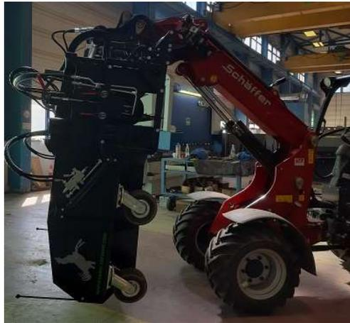
Abbildung 26: Ankippen des Farm-Servant® als Frontanbaugerät
