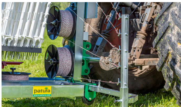
Possibilité d'installer ou d'enrouler jusqu'à 5 fils électro-plastiques à la fois
