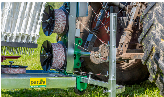
Mogelijkheid om tot 5 strengen tegelijk op- of af te rollen
