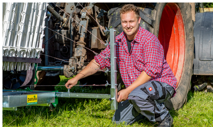
Beidseitiges Arbeiten durch umsteckbaren Auslegearm
